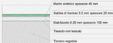
SEZIONE 2-2 - STRATIGRAFIA MANTO NUOVO CAMPO scala 1:20
