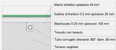
SEZIONE 1-1 - STRATIGRAFIA MANTO NUOVO CAMPO CON PARTICOLARE DEI DRENAGGI scala 1:20
